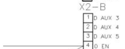
Collegamento all' ingresso encoder LINE DRIVER del controllo numerico
